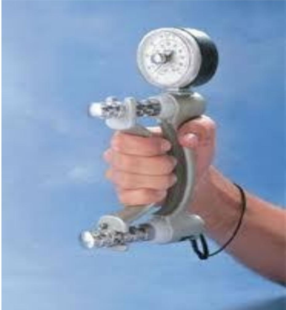
Il dinamometro viene utilizzato per misurare la forza della stretta di mano
