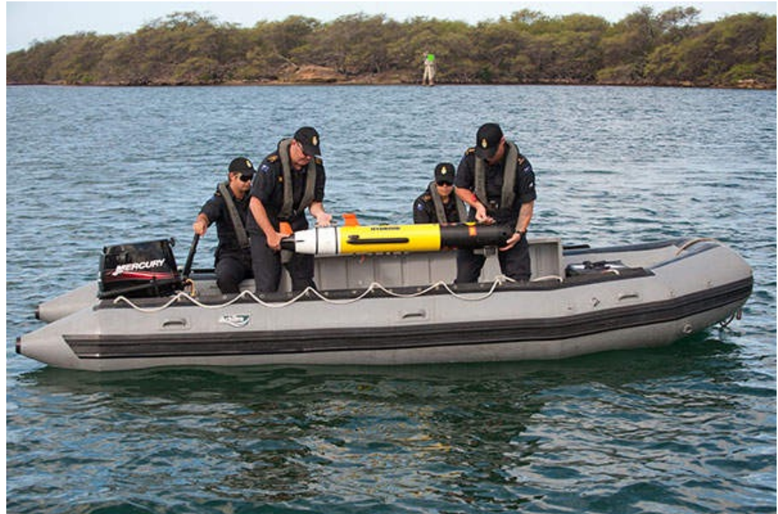
Un AUV per acque basse messo a mare da un gommone (dal sito naval-technology.com )
