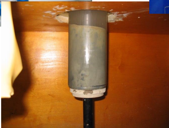
Particolari della camera utilizzata per l'estrusione in ambiente inerte ( N_2 ) del sedimento
