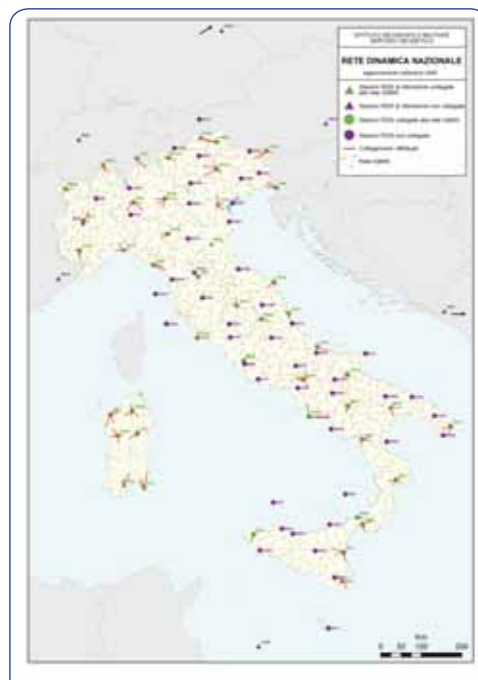
Figura 6 - Collegamenti fra i punti dell'IGM95 e le stazioni dell'RDN.
