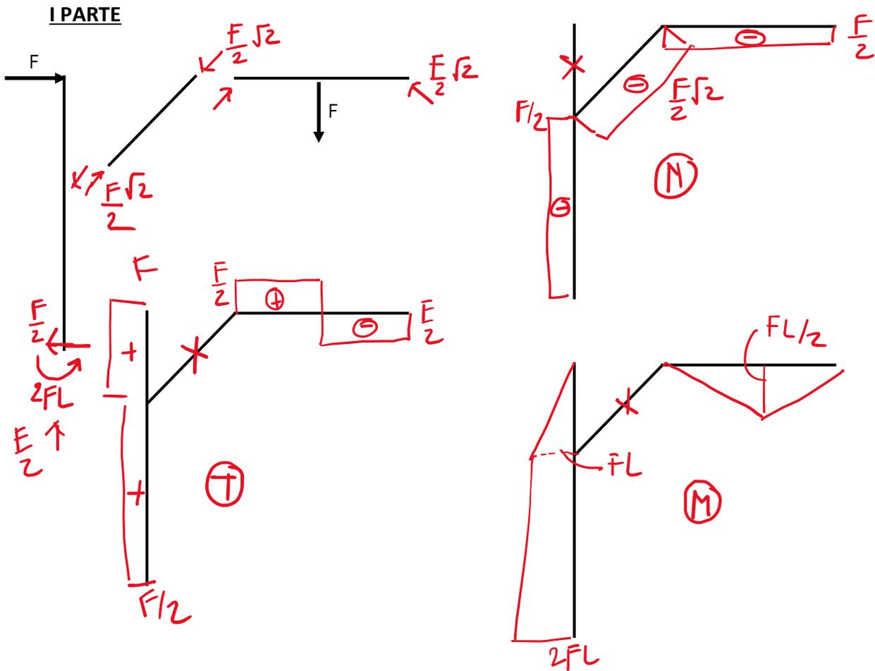
**Quesito n. 2 [5/14].** La struttura assegnata è formata da una mensola verticale di rigidezza flessionale pari ad  $EJ$  e un pendolo sollecitato da una variazione termica negativa costante sulla sezione. Trascurando la deformabilità assiale del pendolo e assumendo un coefficiente di dilatazione termica lineare pari ad  $\alpha$ , risolvere la struttura e tracciare i diagrammi quotati delle caratteristiche della sollecitazione ( $N, T, M$ ).
