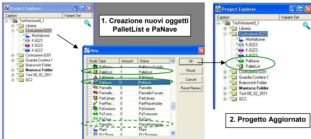
Fig. 5.4 - Creazione degli oggetti Pallet List e PaNave (“nave verde”). Viene evidenziato anche (tratteggiato) l’oggetto “PianoMontaggio”, che verrà creato in un secondo momento (si veda § 5.3.3).
