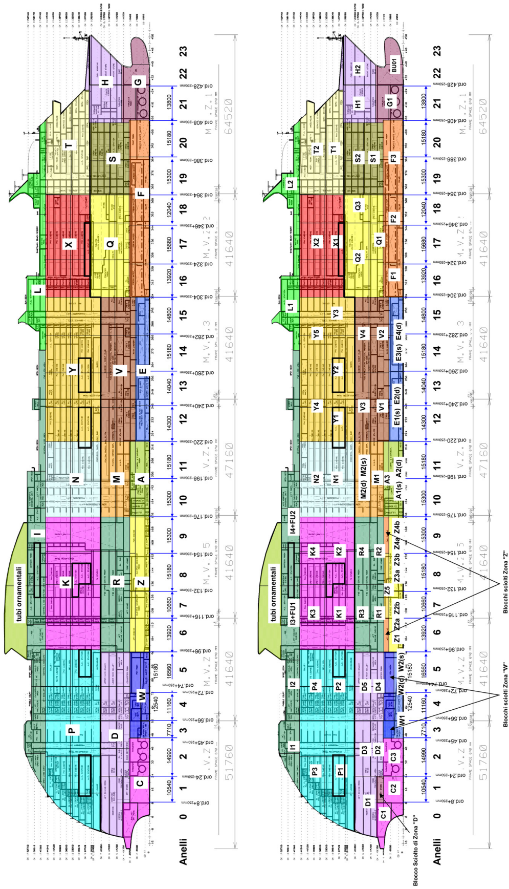
Fig. 2.5 - Suddivisione in Zone (sopra) e Unità di Imbarco / Blocchi Sciolti (sotto) della Costruzione trattata in questa tesi.
