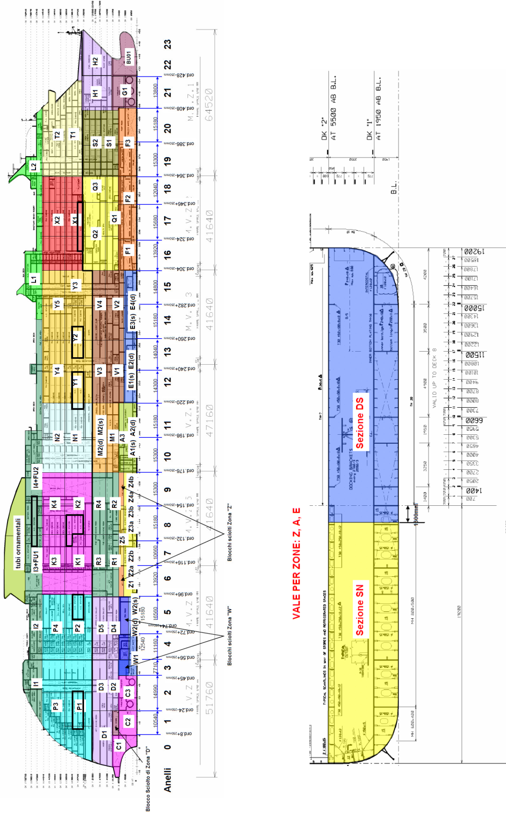
Suddivisione nave in Unità di Imbarco e loro codifica. Individuazione delle Sezioni sinistre (SN) e destre (DN) per le Zone Z, A ed E.
