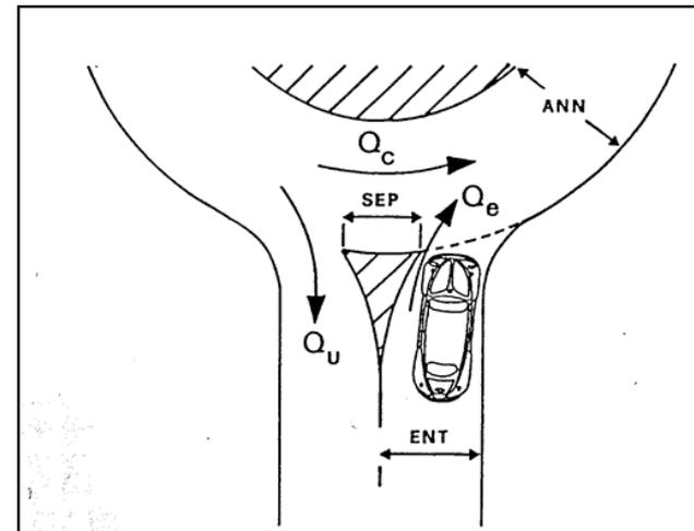
Si consideri una rotondina a quattro bracci avente le seguenti caratteristiche: larghezza anello ANN = 8 m a una corsia; Larghezza bracci entrata ENT = 6 m a una corsia; larghezza isola spartitraffico SEP = 15 m, Raggio isola centrale R = 20 m, larghezza bracci in uscita 6 m
