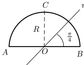
È dato un telaio rigido formato da un semianello omogeneo, di massa  $2m$  e raggio  $R$  e da un'asta omogenea di massa  $m$  saldata al semianello lungo il diametro  $AB$ .
