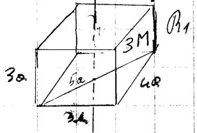
Calcolo, prima, il momento d'inerzia dei due blocchi rispetto all'asse  $z' \parallel AB$  e passante per i due baricentri  $G_1, G_2$ .
