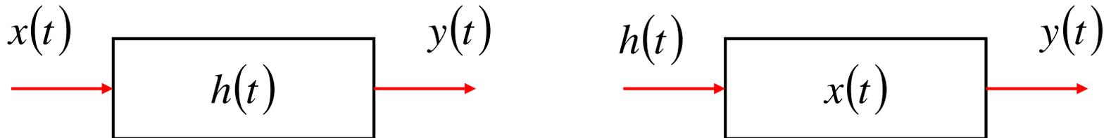
La risposta a  $x(t)$  di un sistema con risposta impulsiva  $h(t)$  è uguale a quella che un sistema, avente risposta impulsiva  $x(t)$ , dà quando al suo ingresso c'è un segnale pari a  $h(t)$ .
