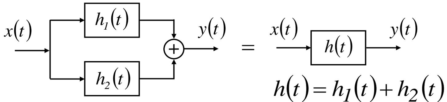
Due sistemi LTI in parallelo equivalgono ad un unico sistema LTI, con risposta impulsiva pari alla somma delle risposte impulsive dei due sistemi
