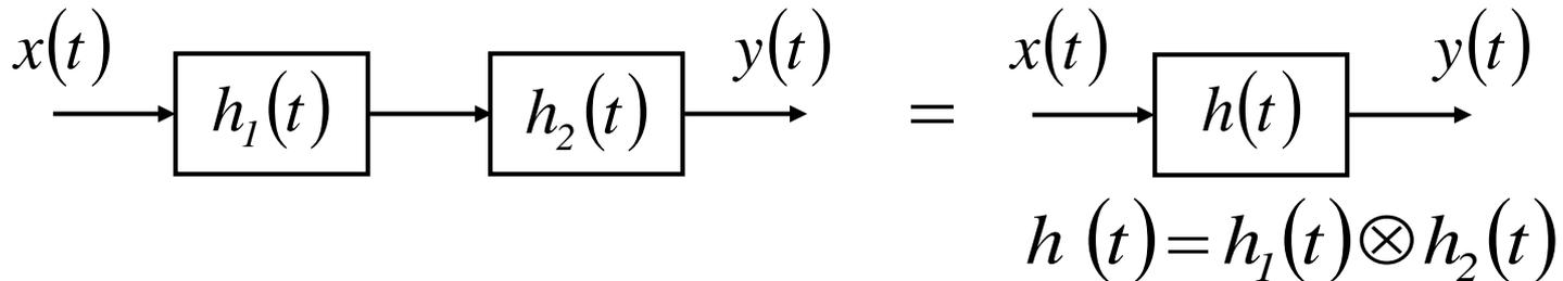
...equivalgono ad un sistema LTI con risposta impulsiva pari alla convoluzione delle risposte impulsive dei due sistemi
