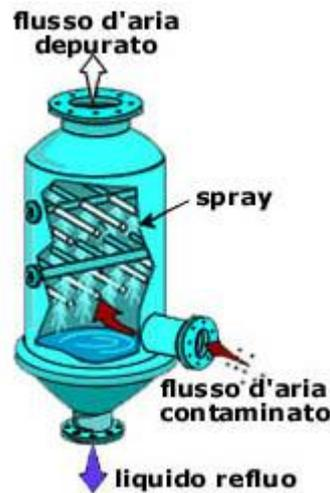
Figura 85 Schema di torre spray
