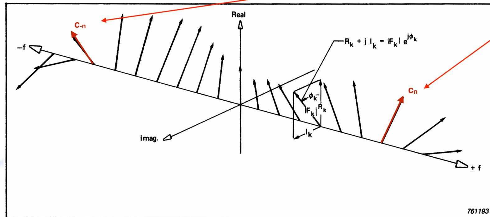
NB la serie di Fourier è definita solo per valori discreti di  $\omega$
