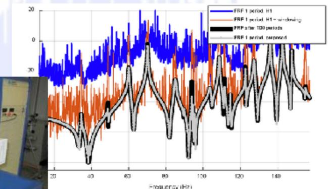
Eccitazione di una struttura per la misura della funzione di risposta in frequenza
