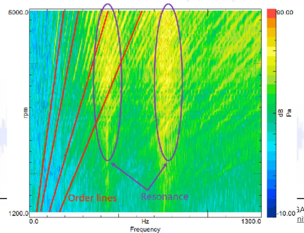
In generale, l'analisi agli ordini è una tecnica particolare che permette di valutare i fenomeni ciclici che si ripetono un numero finito di volte all'interno di un giro completo del rotore
