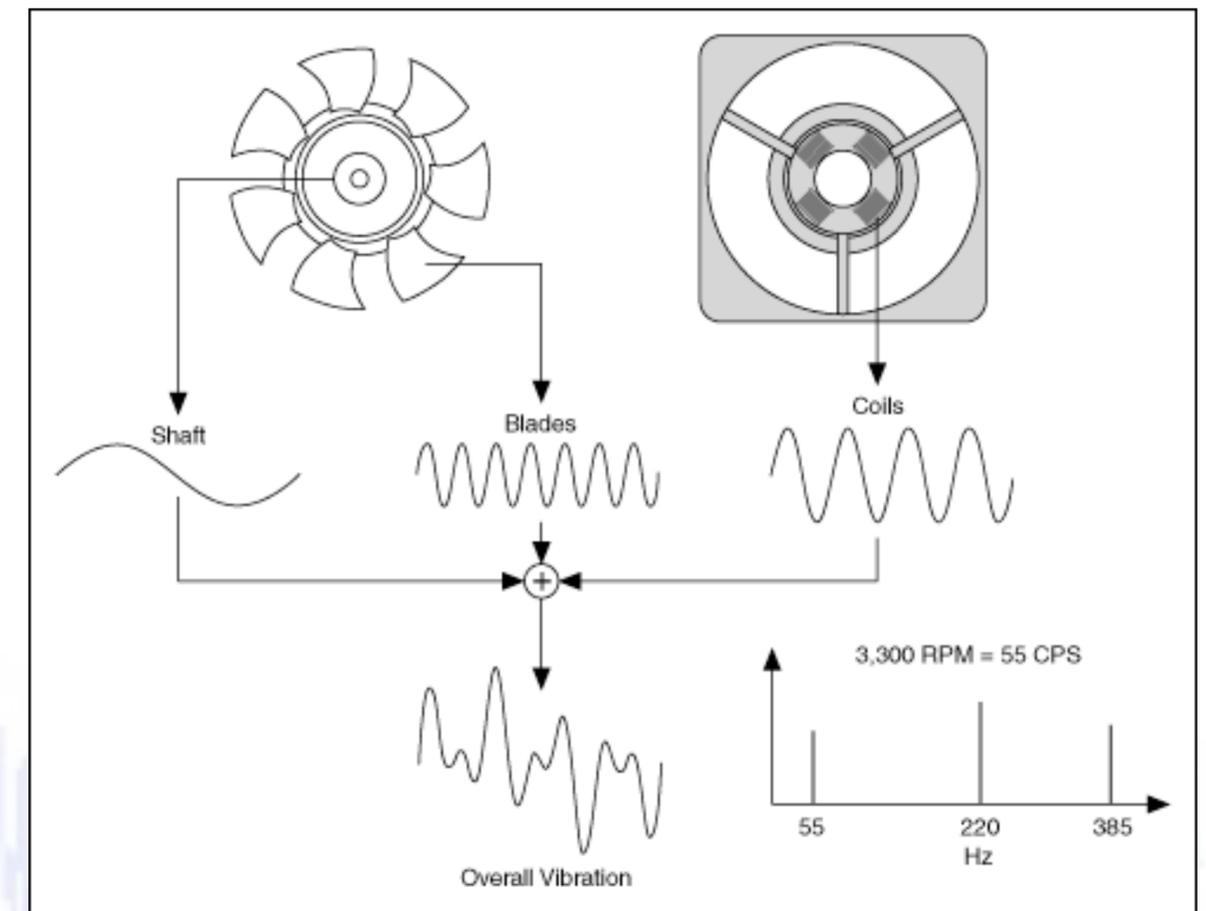
Misurando la vibrazione a velocità variabile gli spettro in frequenza calcolabili fornirebbero risultati poco chiari, con l'analisi agli ordini invece l'effetto di squilibrio, pale e magneti risulterebbero molto più chiari!
