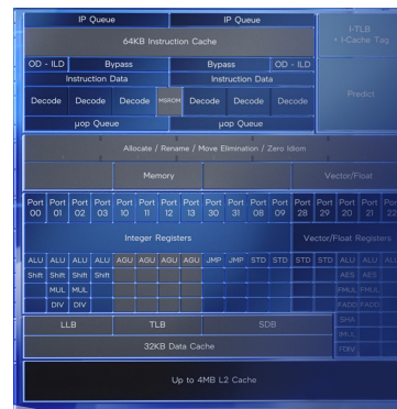
(b) Core efficiente di un processore Intel di dodicesima generazione (azzurro)
