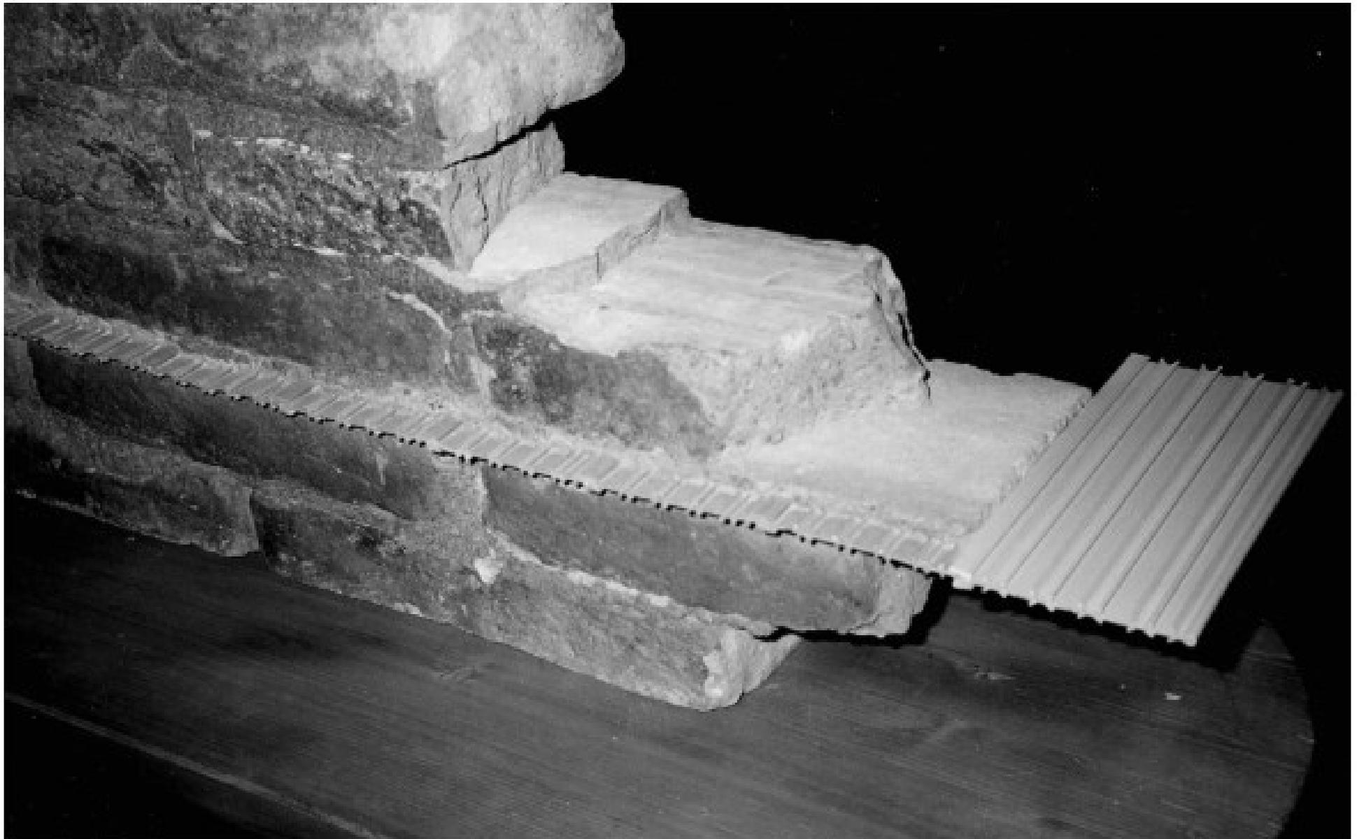
Figura 2 • Taglio meccanico della muratura: barriera con lamine impermeabili.
