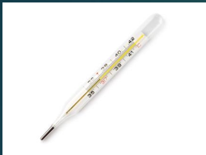
Termometro in vetro e Galinstan ( gallio – indio – stagno ) Tempi di misurazione 5 -10 min.
