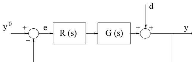
Figura 1: Progetto di un regolatore a tempo continuo.
