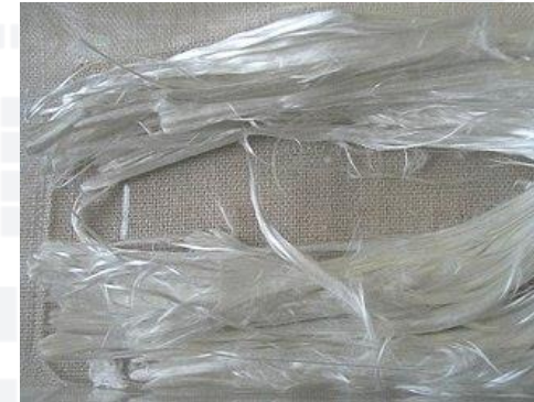
Fibre di amianto
