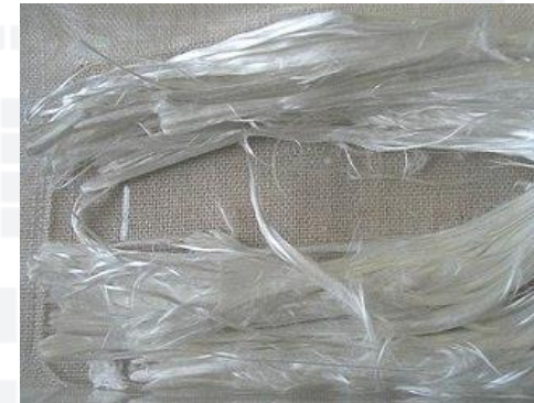
Fibre di amianto
