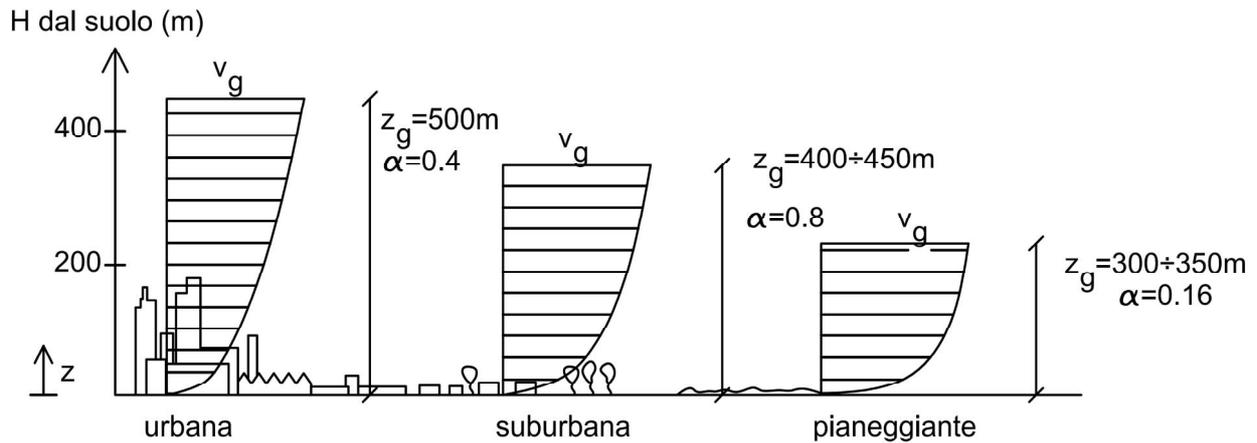
dove  $z_g$  viene detta altezza del gradiente e  $v_g$  velocità dello strato indisturbato o velocità del gradiente, velocità legata al solo gradiente di pressione in quota.
