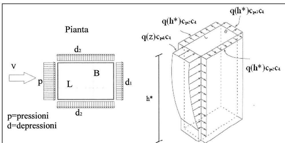
In generale i valori dei coefficienti  $c_{pe}$  dipendono dalle dimensioni geometriche in pianta dell'edificio e dall'inclinazione della parete rispetto alla direzione del vento incidente, secondo i seguenti schemi.
