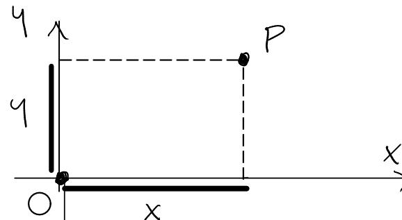
$x (x_p)$  : lunghezza del segmento tra O e la proiezione di P su asse  $x$  con segno - se proiezione è dalla parte opposta della freccia rispetto a O
