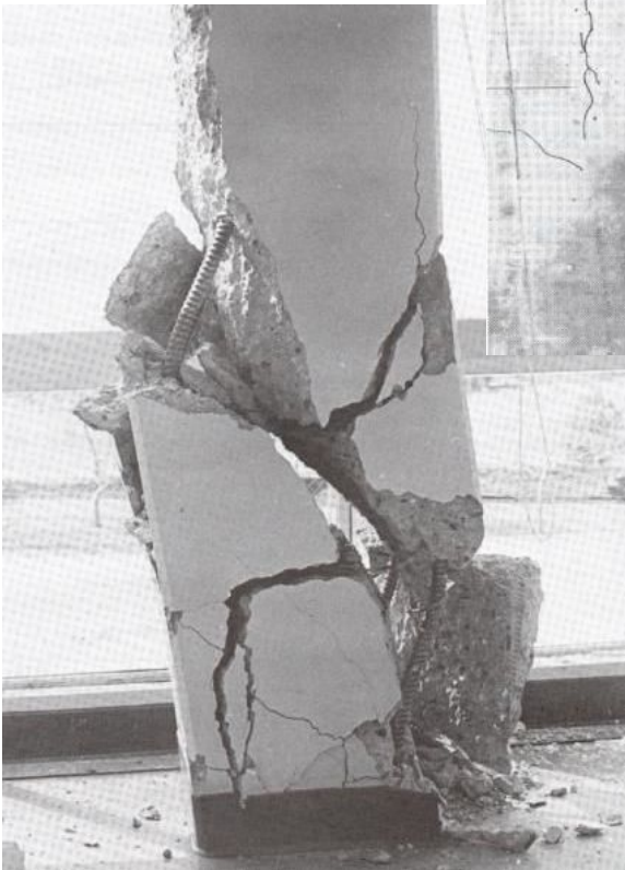
Instabilizzazione barre di armatura compresse per eccessiva spaziatura delle staffe
