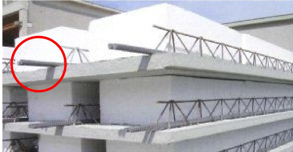
L'armatura di intradosso è solitamente costante su tutta la lunghezza del travetto e si interrompe in prossimità degli appoggi
