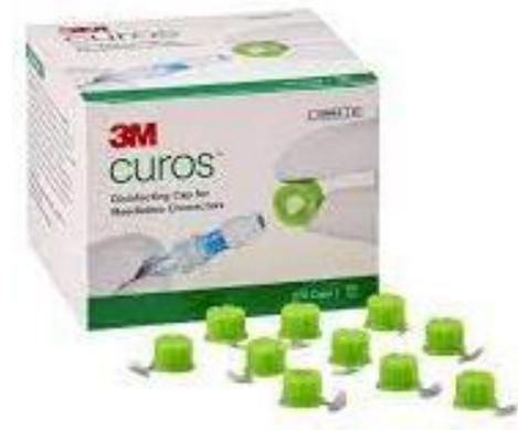
**La disinfezione passiva e continua:** tappino a valvola (port protectors) che si avvita con sistema luer lock. All'interno del tappino è presente una spugna satura di alcool al 70% che durante l'avvitamento viene compressa e aderisce al setto. I tappi di disinfezione sono monouso e devono essere cambiati dopo ogni utilizzo.
