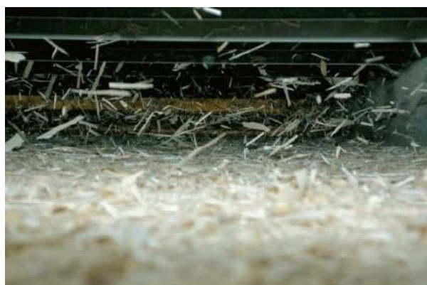
Distribuzione dei trucioli dello strato centrale
