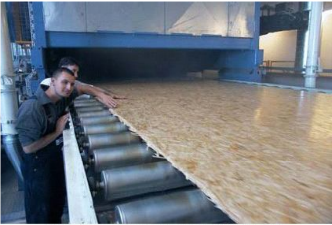
Pannello „ininterrotto“ sui rulli della pressa
