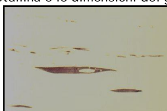
Stringler longitudinali di inclusioni (esame macroscopico).
