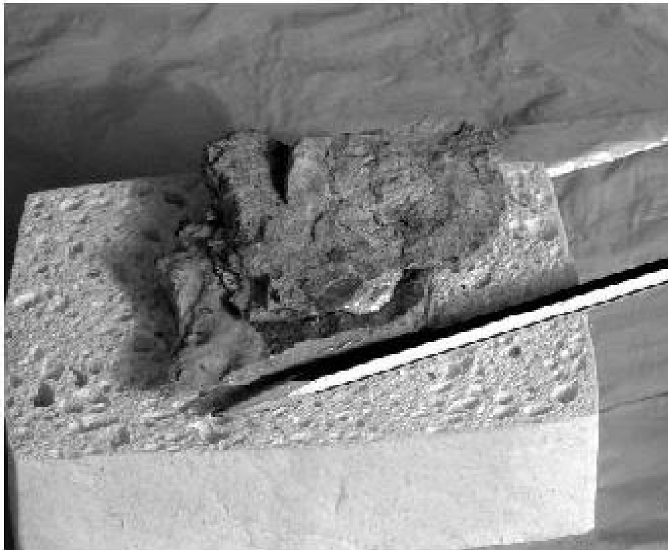
Figura 2 • Le parti vengono avvicinate esercitando una leggera pressione. Durante la fase di indurimento dell'adesivo, può rendersi necessario bloccare provvisoriamente le scaglie o le parti da incollare con vincoli provvisori (ad esempio strisce di carta giapponese o di nastro adesivo, oppure morsetti di legno, per non danneggiare i manufatti) previamente preparati.
