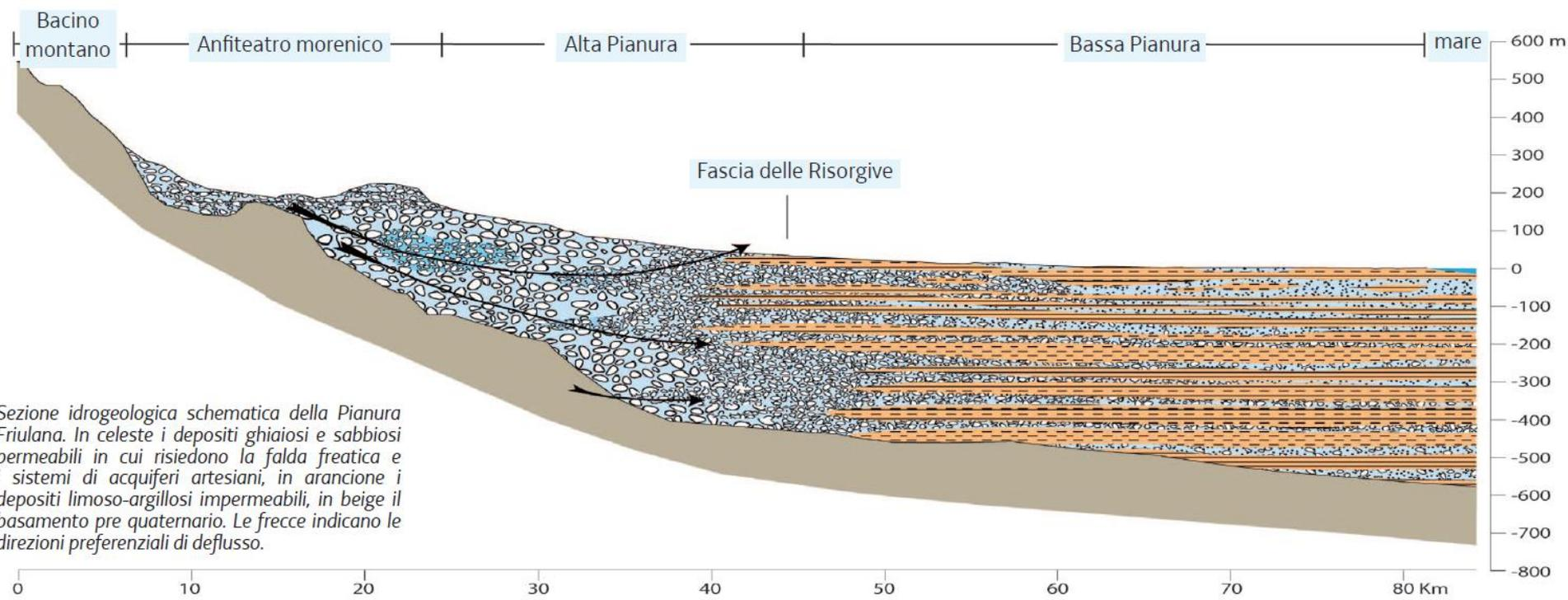
Sezione idrogeologica schematica della Pianura Friulana. In celeste i depositi ghiaiosi e sabbiosi permeabili in cui risiedono la falda freatica e i sistemi di acquiferi artesiani, in arancione i depositi limoso-argillosi impermeabili, in beige il basamento pre quaternario. Le frecce indicano le direzioni preferenziali di deflusso.
