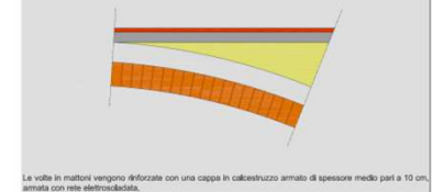
Tipologia S04 Volte rinforzate con cappa in calcestruzzo armato
