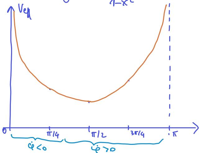
In questo caso  $\theta_0 < \theta^*$ . Il potenziale non è simmetrico e la regione di  $\theta$  in cui  $\dot{\phi} > 0$  è più estesa di quella in cui  $\dot{\phi} < 0$ . In media la frotole si muove con  $\dot{\phi}_{media} > 0$ .
