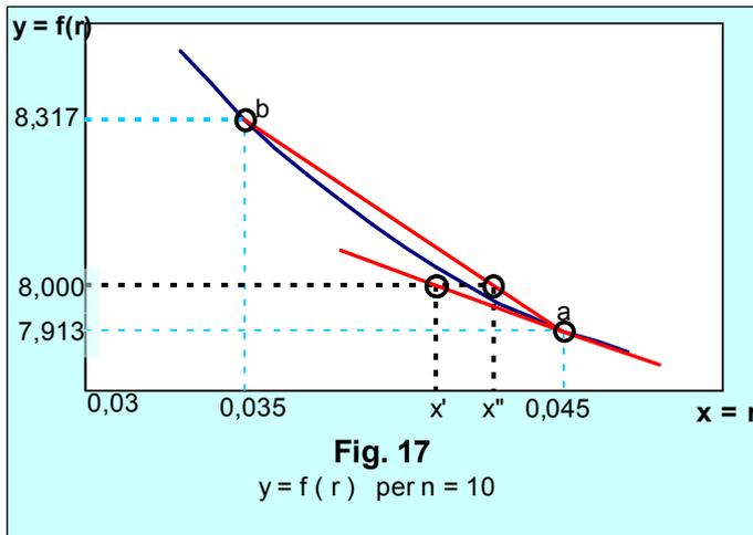
Se conosciamo con esattezza il valore della funzione anche in un altro punto  $b$ , tale che  $x_b < x < x_a$ , con  $y_b = 8,317$  corrispondente a  $x_b = 0,035$ , possiamo ricorrere all'interpolazione lineare (fig. 17)
