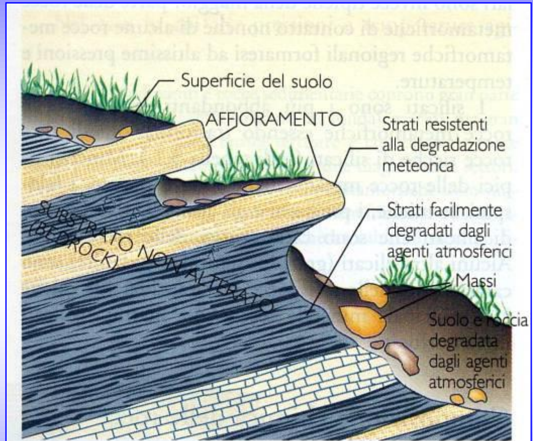
Figura 3.6. Sezione geologica attraverso la superficie terrestre che mostra la relazione tra l'affioramento di una roccia che forma il substrato non alterato («bedrock») e il suolo.
