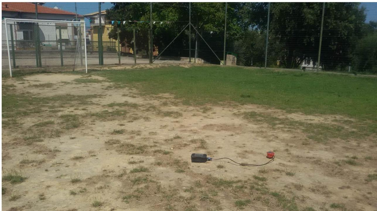
**Foto 1 - Esecuzione di un'indagine tramite tromografo**
