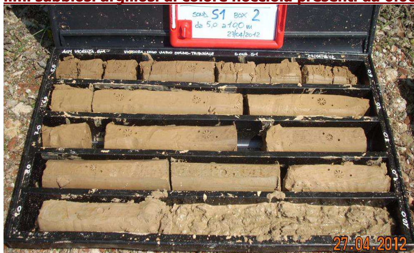
FOTO N.1: sabbie limose-argillose giallastre della Formazione delle alluvioni limo sabbiose (da INDAGINE GEOLOGICA GEOTECNICA SUI TERRENI INTERESSATI DAL PROGETTO DI VIABILITA' DI COLLEGAMENTO DI VIALE DELLO STADIO CON AREA NUOVO TRIBUNALE IN COMUNE DI VICENZA - Dr. Darteni)
