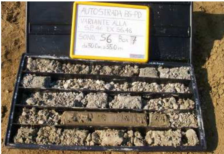
FOTO N.6: ghiaie e sabbie della Formazione delle alluvioni (da INDAGINE GEOLOGICA VARIANTE SP 46 – Provincia di Vicenza)
