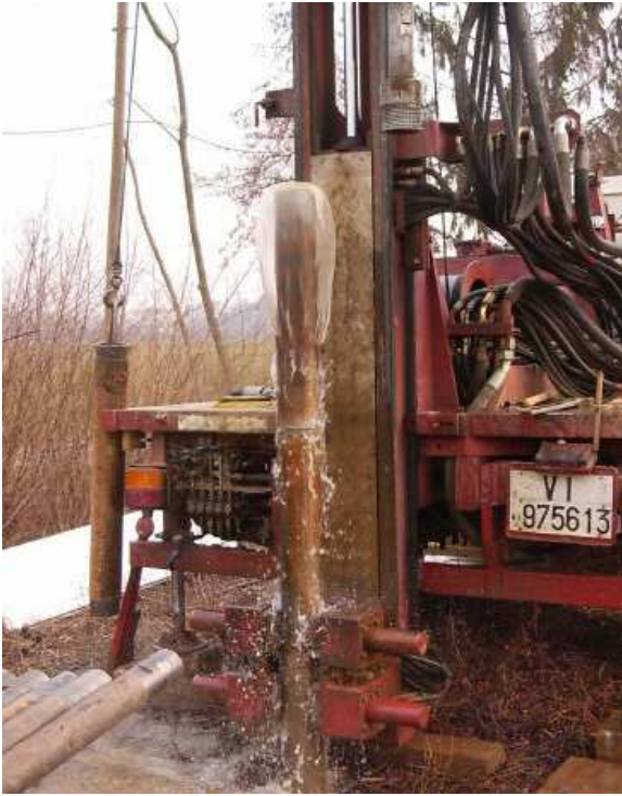
Figura 15: falda idrica in pressione a -34m dal p.c.: CAMPAGNA GEOGNOSTICA: dallo studio geologico per la variante alla S.P.46 VICENZA-ISOLA V.NA
