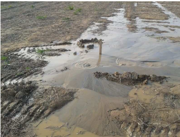
Figura 16: falda idrica in pressione a -27m risalita dal foro di una prova penetrometrica CPTU: ns. archivio
