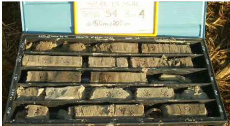
FOTO N.3: sabbie limose fini grigie della Formazione delle alluvioni (da INDAGINE GEOLOGICA VARIANTE SP 46 – Provincia di Vicenza)
