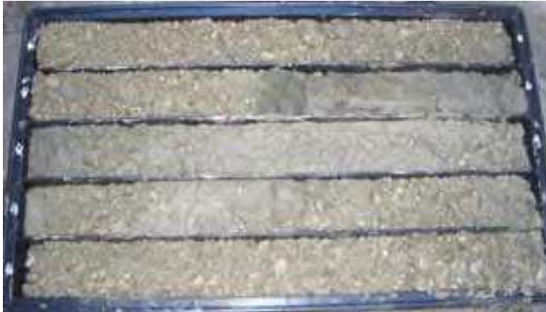
FOTO 5: ghiaie e sabbia alluvionali, da Studio geologico per SCAMBIO TERMICO BASILICA PALLADIANA – Sinergeo srl)
