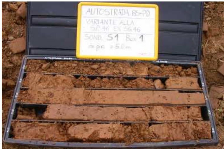
FOTO N.2: sabbie limose-argillose nocciola della Formazione delle alluvioni limo sabbiose (da INDAGINE GEOLOGICA VARIANTE SP 46 – Provincia di Vicenza)
