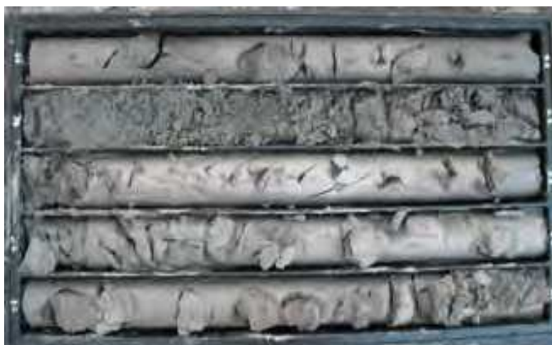
FOTO 4: sabbie fini alluvionali, da Studio geologico per SCAMBIO TERMICO BASILICA PALLADIANA – Sinergo srl)
