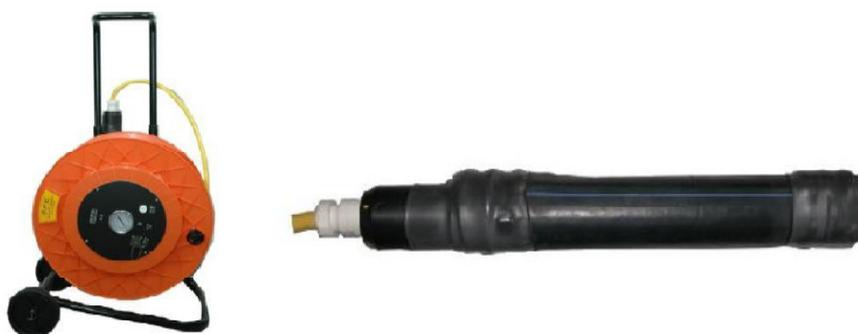
**fig. 24 - Il sensore DH S5 (da <http://www.maelettronica.it/>): a sinistra, la bobina del cavo di collegamento sonda/sismografo; a destra: la sonda**
