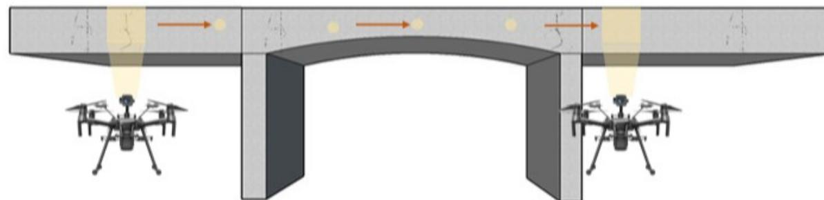
b) Acquisizione di immagini mediante metodo di scansione
