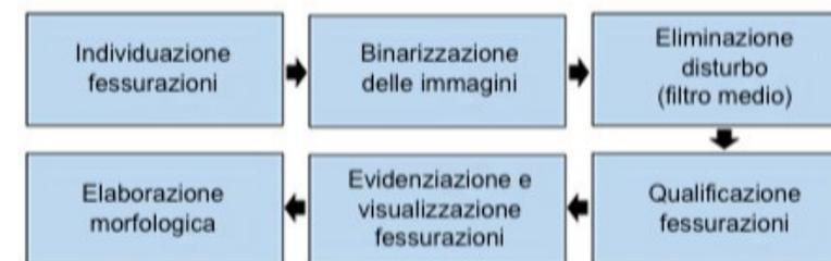
d) Quantificazione fessurazioni utilizzando l'elaborazione delle immagini
