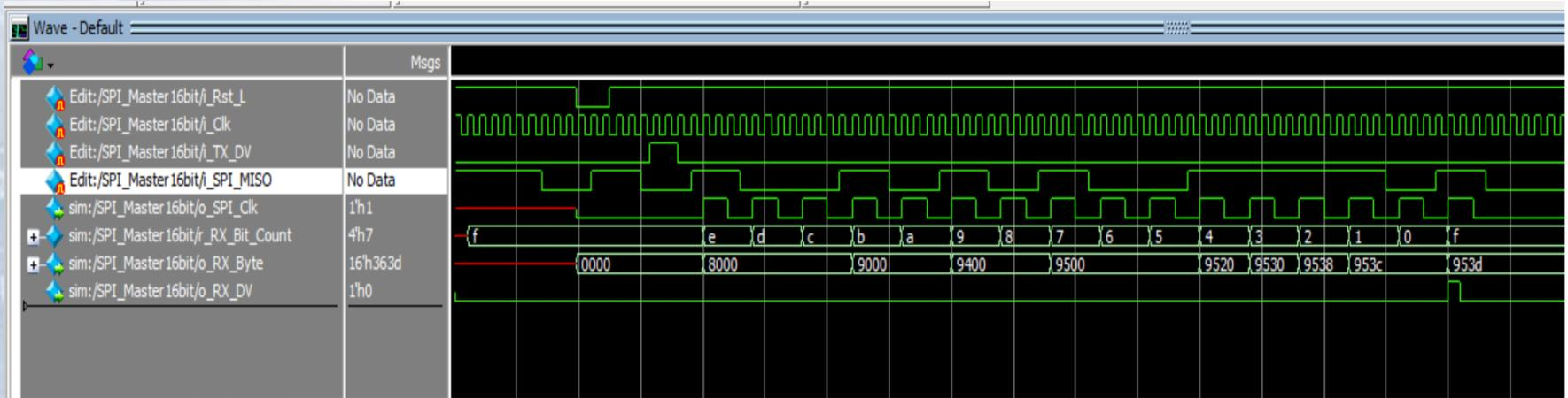
**Nota:** se **non** si attiva i\_TX\_DV non viene generato SPI\_Clk e quindi il dispositivo non è in grado di scrivere su SPI ma al contempo nemmeno di leggere da SPI
