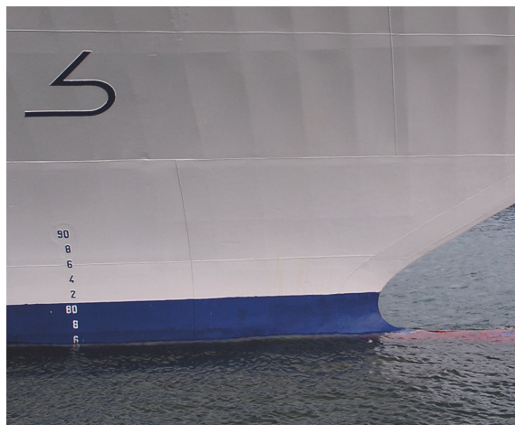
Fig. 8.1.3.1b. Nave con scale delle immersioni posizionate fuori dalle perpendicolari (Trieste 2012, foto dell'Autore)
