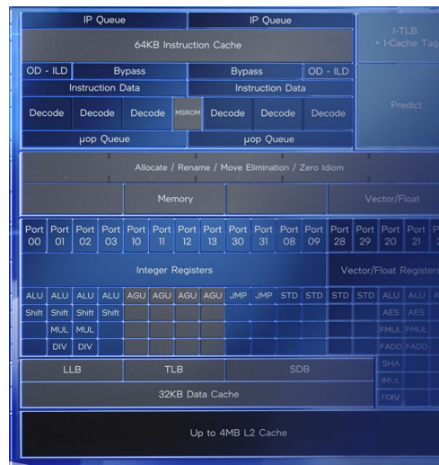
Core efficiente di un processore Intel di dodicesima generazione (azzurro)
