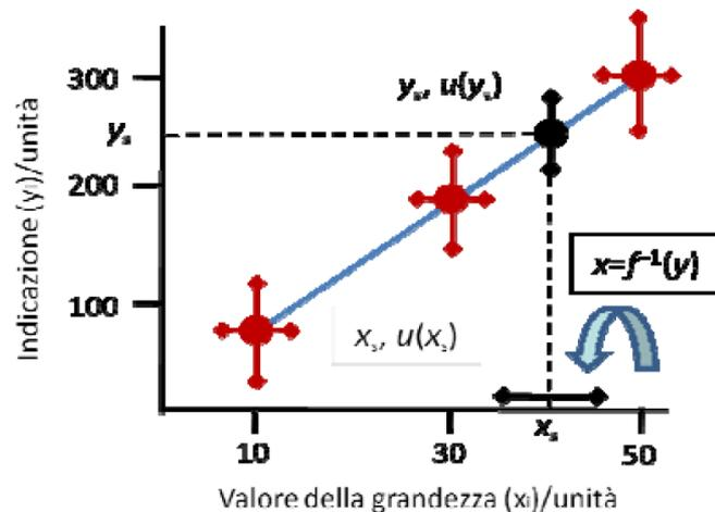
Schema del diagramma di taratura che illustra la seconda parte della definizione di taratura. Le indicazioni  $y_s$  derivanti da un campione di prova corrispondono ad un valore della grandezza  $x$ . Le frecce orizzontali e verticali indicano rispettivamente l'incertezza tipo delle indicazioni e dei valori della grandezza.
