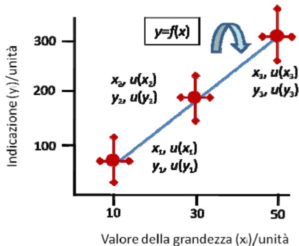
Schema della prima parte della definizione di taratura. Le indicazioni  $y_i$  derivanti dai campioni di misura (calibratori) con valori della grandezza  $x_i$  danno la relazione (la funzione)  $y = f(x)$ . Le frecce orizzontali e verticali indicano rispettivamente le incertezze tipo delle indicazioni e dei valori della grandezza (queste non sono in scala).
