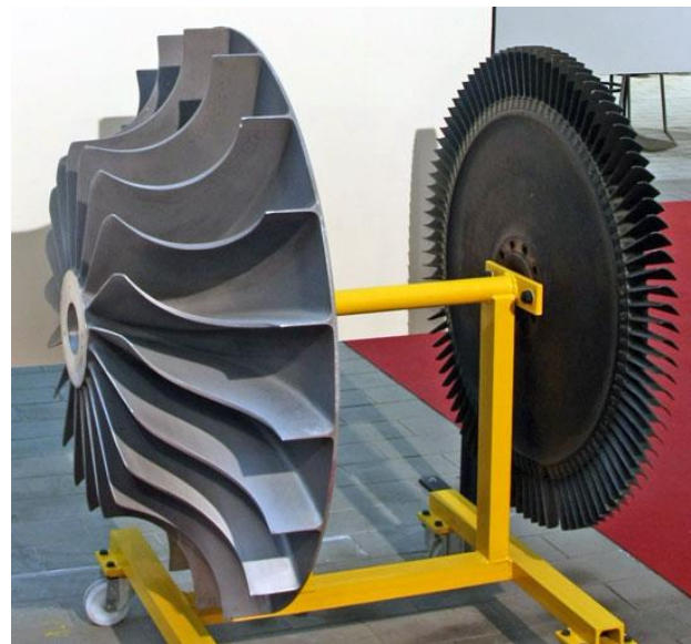
Compressore e turbina del turbogetto De Havilland Ghost.
