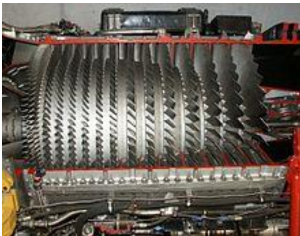
Compressore assiale (macchina termica operatrice dinamica).
