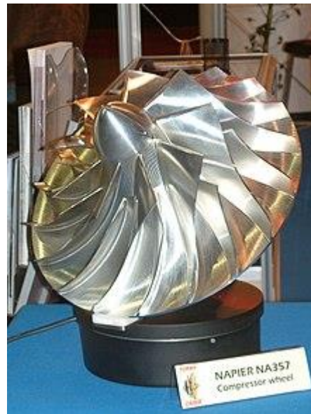
Compressore radiale (macchina termica operatrice dinamica).
