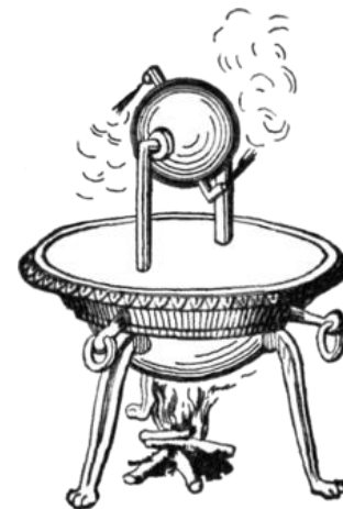
Mulinello di Erone o eolipila, IV secolo.
