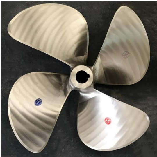
Elica marina (macchina idraulica operatrice dinamica).
