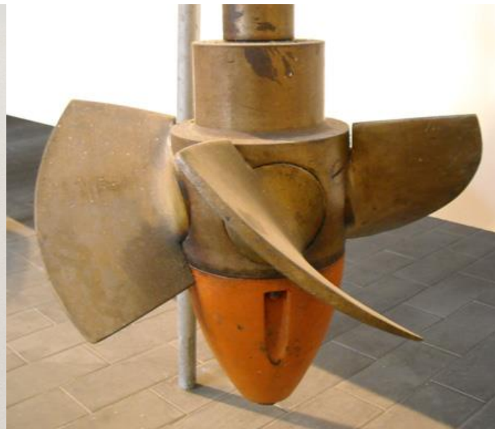
Girante di turbina Kaplan (macchina idraulica motrice dinamica assiale).
