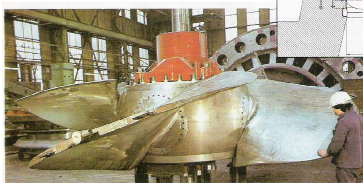
Sezione principale di una turbine a flusso assiale (Kaplan) con caduta utile di 6m, velocità di rotazione 1,3 giri/s, Potenza 6.88 MW e fotografia della girante in officina (Voith).
