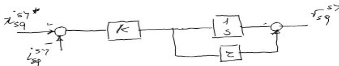
Eqng. vettoriale corrispondente è  $\bar{v}_s^{sy} = K \left( c + \frac{1}{s} \right) \left( \bar{i}_s^{sy*} - \bar{i}_s^{sy} \right)$
