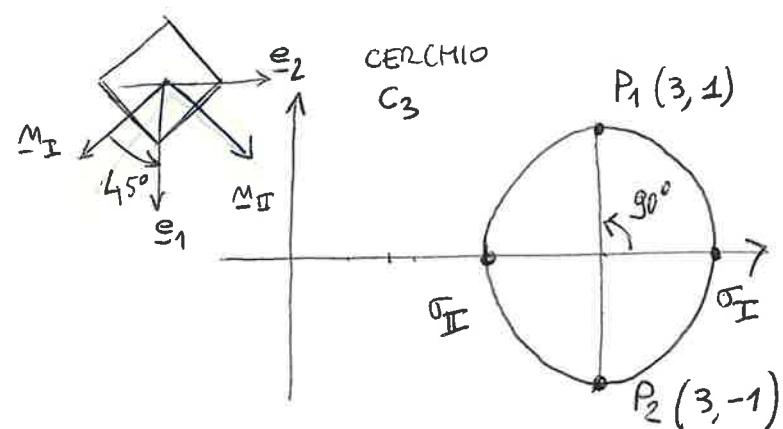
Essendo  $e_3$  già direzione principale il cerchio  $C_3$  (individuato da  $\sigma_{\text{II}} = 2$  e da  $\sigma_{\text{I}} = 4$ ) descrive tutti gli stati tensionali relativi alle giaciture aventi nomi contenute nel piano  $e_1, e_2$  o, equivalentemente,  $m_I - m_{\text{II}}$ . La massima tensione tangenziale, tra queste giaciture, si ha proprio per le facce dinomelle  $e_1$  (punto nel piano di Mohr  $P_1$ ) ed  $e_2$  ( $P_2$  nel piano di Mohr).
