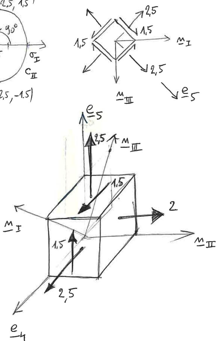
Nel sistema  $e_4, m_{II}, e_5$  il tensore degli sforzi  $\underline{\sigma}$  risulta:
