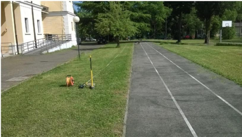
Ubicazione dello stendimento relativo alla prova geofisica tipo MASW
