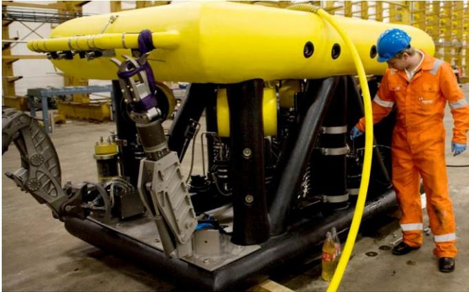
Le grandi dimensioni rispetto ai precedenti permettono di equipaggiarli con motori molto potenti, quindi la profondità operativa è maggiore. La comunicazione con la superficie avviene attraverso un cavo ombelicale che utilizza fibre ottiche per la telemetria e la trasmissione dei dati, e cavi di potenza per l'alimentazione dei motori e di tutta la strumentazione installata. Per la messa a mare e il recupero vengono impiegati degli appositi sistemi denominati LARS (Launch And Recovery System).
