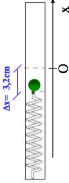
La molla di un fucile è compressa di  $\Delta x = 3,2 \text{ cm}$  e spara un proiettile di massa  $m = 12 \text{ g}$ . Sapendo che la costante elastica della molla è di  $k = 750 \text{ N/m}$ , determinare con quale velocità esce il proiettile
