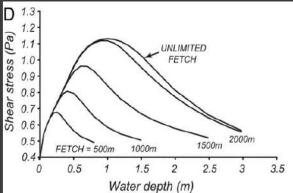
❖ Modello di Fagherazzi et al. (2006): sforzo di taglio delle onde da vento in funzione della profondità:
