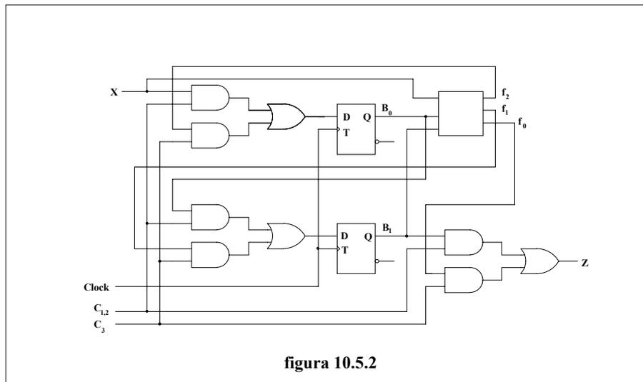
Normalmente l'uscita  $z$  del circuito, se dipende dai segnali di controllo, verra' realizzata con un gate OR. Ad ogni passo, cioe' ad ogni impulso di clock, ad un ingresso dell'OR verra' riportato il valore da trasferire in uscita, mentre nel contempo gli altri ingressi dovranno esser posti a zero. Pertanto ciascun segnale di controllo del passo ed il relativo valore di uscita verranno portati all'ingresso di un AND della rete logica a due livelli che realizza  $z$ .
