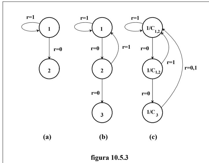
Il circuito di controllo sarà pertanto un circuito di Moore che fornirà un'uscita a livelli per tutta la durata di ciascun passo. Si noti che il circuito ha due uscite di cui solamente una può essere diversa da 0 a ciascun istante. Per semplicità di notazione a ciascuno stato è stata associata solo l'uscita che in corrispondenza a quello stato è diversa da 0.
