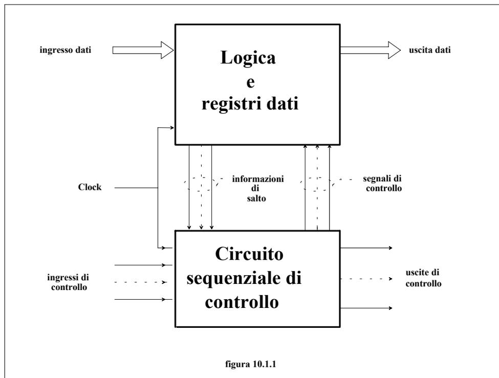
Il blocco superiore consiste in un insieme di registri di dati interconnessi da una logica combinatoria, mentre il blocco inferiore fornisce una sequenza di segnali di controllo, che gestiscono, in unione al clock, l'appropriato trasferimento dei dati tra i registri.
