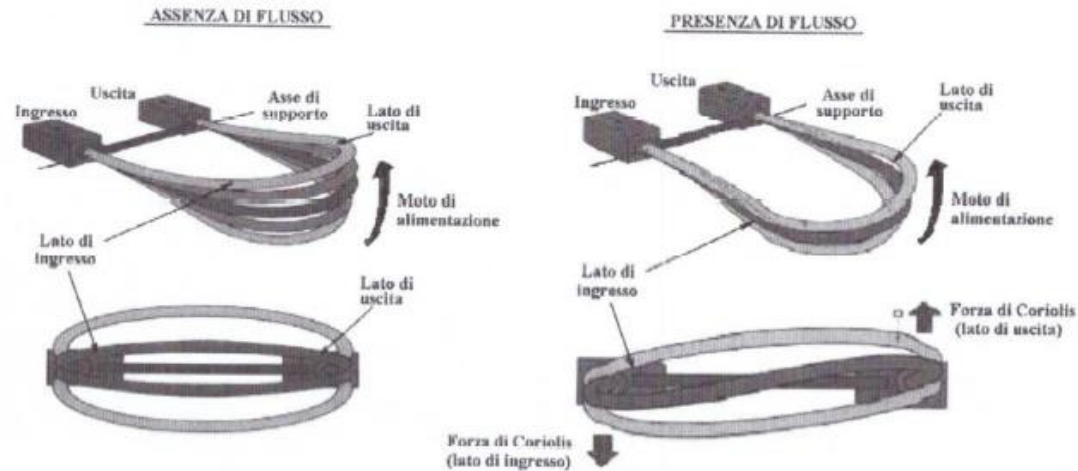
Figura 2.32 – Deformazioni indotte nella tubazione di misura
