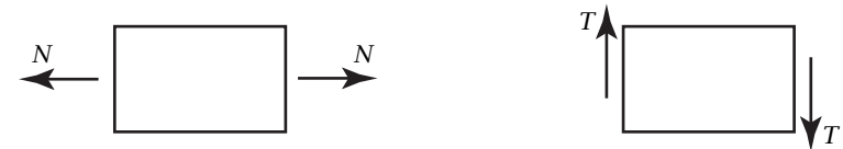
Figura 2.2: Convenzioni di segno di forza normale e taglio
